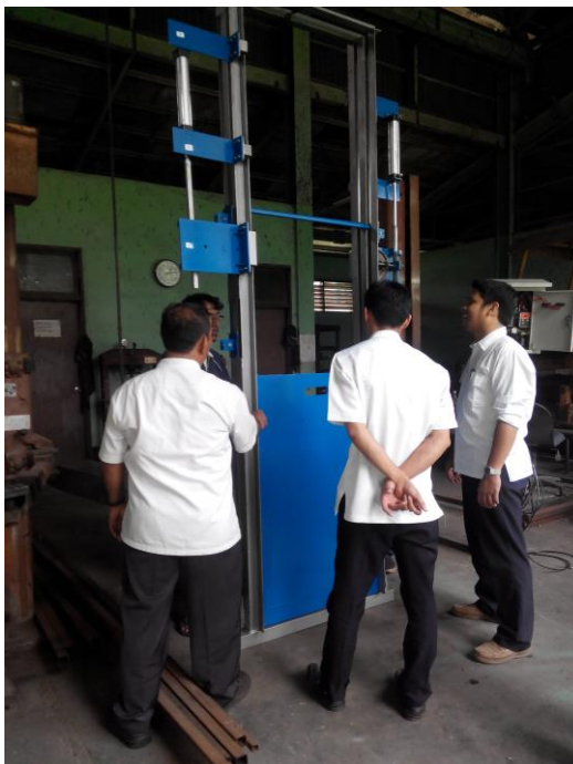
Gambar 3 Ujicoba elektromekanis pintu di Laboratorium Balai Irigasi
